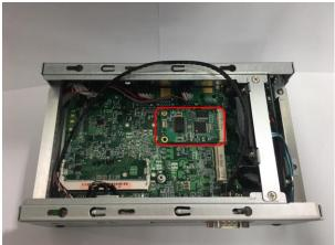
Step 9 Connect the CAN Bus cable to the mini PCIe module.
